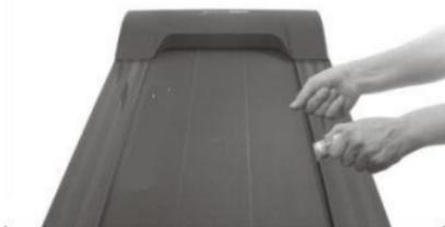
Silně naáhněte běžecký pás. Poté aplikujte silikonový olej. Poté spustte stroj 3 minuty bez zatížení. Výše uvedená činnost se doporučuje opakovat každých 30 hodin provozu stroje. To pomůže prodloužit životnost dílů.
