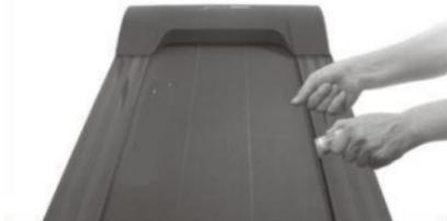
Puxe a cinta com firmeza. Em seguida, aplique óleo de silicone. Em seguida, inicie a máquina por 3 minutos sem carga. Recomenda-se que o procedimento acima seja repetido a cada 30 horas de operação da máquina. Isso ajudará a prolongar a vida útil das peças.
