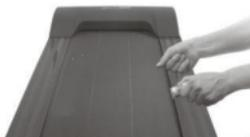
Τραβήξτε καλά τον ιμάντα κίνησης. Στη συνέχεια, βάλτε το λάδι σιλικόνης στο πινακά τρεξιματος. Στη συνέχεια ξεκινήστε το μηχανήμα για 3 λεπτά χωρίς φόρτωση. Είναι προτιμότερο να διατηρείται έτσι κάθε 30 ώρες λειτουργίας του μηχανήματος. Αυτό μπορεί να εξοικονομήσει σωστά τη διάρκεια ζωής των εξαρτημάτων.
