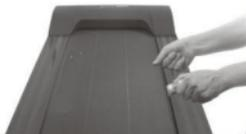
Ziehen Sie das Band fest. Tragen Sie das Silikonöl auf. Schalten Sie dann das Gerät für 3 Minuten ohne Last ein. Es wird empfohlen, die obige Tätigkeit alle 30 Stunden des Betriebs zu wiederholen. Damit wird die Lebensdauer des Geräts verlängert.
