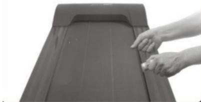
Čvrsto povucite traku za trčanje. Nakon toga nanosite silikonsko ulje. Zatim pustite uređaj 3 minute bez opterećenja. Gornji postupak preporučuje se ponoviti svakih 30 sati rada uređaja. To će vam pomoći produžiti život dijelova.
