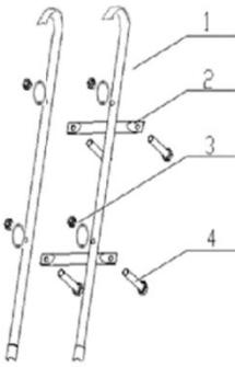
Montavimo rinkinyje esančiais varžtais ir veržlėmis jungdami elementus, pritvirtinkite kopėtelės.
