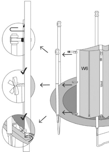
**UWAGA:** Upewnij się, że wszystkie mocowania siatki zostały zainstalowane poprawnie i są mocno zaciśnięte.
