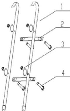
Montieren Sie die Leiter, indem Sie die Elemente mit Schrauben und Muttern aus den Montagesatz verbinden.
