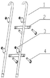
Montavimo rinkinyje esančiais varžtais ir veržlėmis jungdami elementus, pritvirtinkite kopėtėles.
