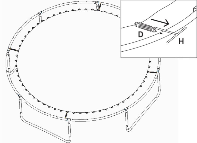
Для сохранения равномерного натяжения мата пружины следует устанавливать попеременно по 4 сторонам рамы - первую установить на 12 часов рамы, вторую на 6 часов, третью на 9, а четвертую на 3 часа. Остальные установить аналогично с 4 сторон рамы.
