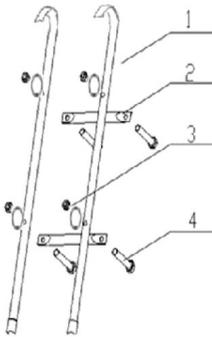
Zamontuj drabinkę łącząc ze sobą elementy za pomocą śrub i nakrętek z zestawów montażowych.
