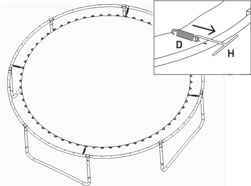
Um eine gleichmäßige Spannung der Matte zu gewährleisten, sind die Federn abwechselnd auf vier Seiten des Rahmens anzubringen - die erste an die 12-Uhr-Position, die zweite an die 6-Uhr-Position, die dritte an die 9-Uhr-Position und die vierte an die 3-Uhr-Position montieren. Die weiteren befestigen Sie analog auf 4 Seiten des Rahmens.
