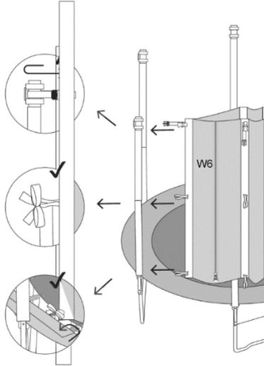
**DĖMESIO:** Patikrinkite, ar visos tinklo tvirtinimo jungtys yra tinkamai pritvirtintos ir stipriai prispaustos.
