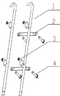
Zamontuj drabinę łącząc ze sobą elementy za pomocą śrub i nakrętek z zestawów montażowych.
