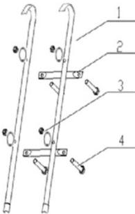
Установить лестницу, соединяя между собой элементы с помощью болтов и гаек из монтажных комплектов.
