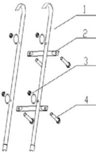
Montați scara conectând toate piesele cu ajutorul șuruburilor și piulițele din seturile de montaj.
