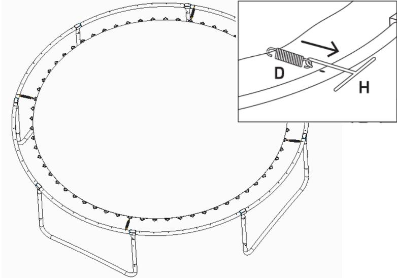
Norėdami išlaikyti tolygų šokinėjimo pagrindo įtempimą, spyruokles kabinkite pakaitomis keturiose rėmo pusėse: pirmąją pritvirtinkite 12 val., antrąją 6 val., trečiąją 9 val., o ketvirtąją 3 val. padėtyje. Toliau tvirtinkite analogiškai keturiose rėmo pusėse.
